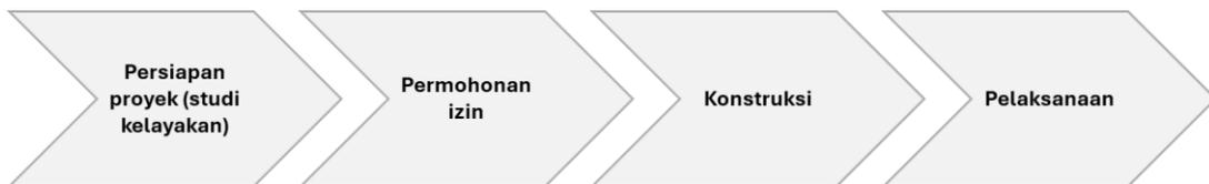
Gambar 5: Tahapan umum pengembangan pembangkit listrik tenaga bayu
