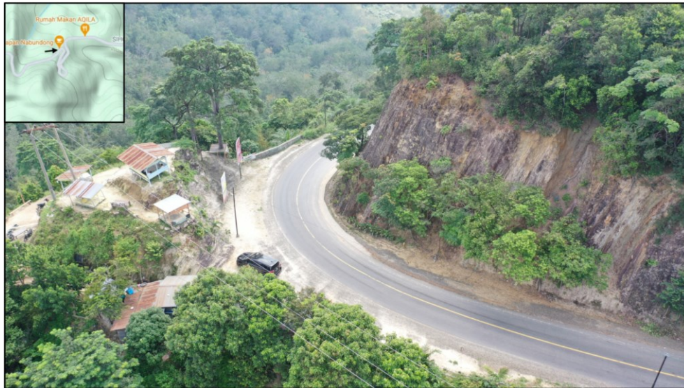
Gambar 24. Bagian dari tikungan tajam di utara menampilkan dinding batu di kedua sisi; singkapan batu yang lebih kecil diperkirakan tingginya sekitar 8 m.
