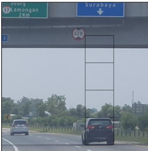
Gambar 17. Ketinggian jembatan di atas permukaan jalan tampak lebih dari 4,2 m. Sebagai perbandingan, tinggi Toyota Innova Reborn ini sesuai spesifikasinya adalah 1,795 m.
