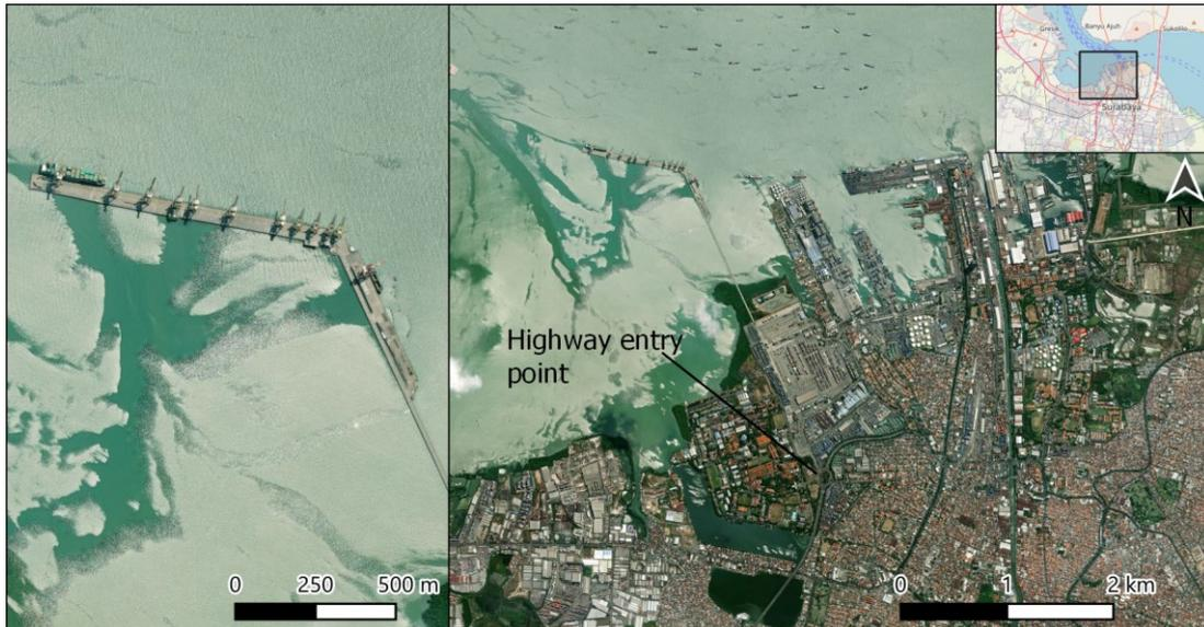
Gambar 15. Citra satelit Pelabuhan Surabaya. Jalan masuk/keluar di bagian barat pelabuhan dan masuk jalan raya sejajar sehingga pelabuhan ini cocok untuk pengangkutan komponen turbin angin yang panjang.
