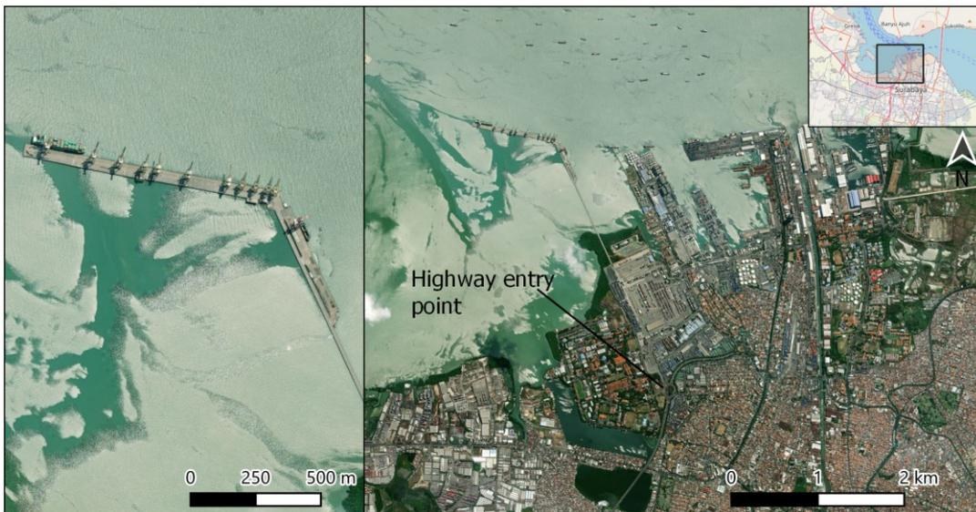
Gambar 15. Pelabuhan Surabaya. Jalan masuk / keluar bagian barat pelabuhan dan masuk jalan raya sejalan, yang membuat pelabuhan ini cocok untuk pengangkutan komponen turbin angin yang panjang.
